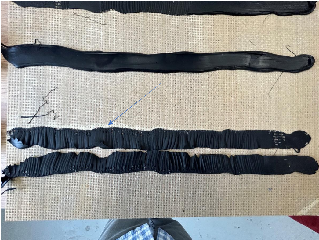
Płyta A przygotowana Cleanerem I (strzałką zaznaczone odspojenie)
